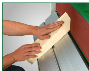
Szlifowanie cięć ukośnych do 45° poprzez pochylenie stołu
