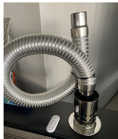
Wylot spalin w górnej części obudowy
