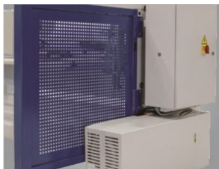
Panelowa zabudowa bezpieczeństwa
