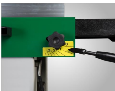
Przestawienie grubości wióra za pomocą dźwigni obsługowej.
