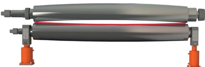
Grubość gięcia jest grubsza niż ukoronowanie walca
