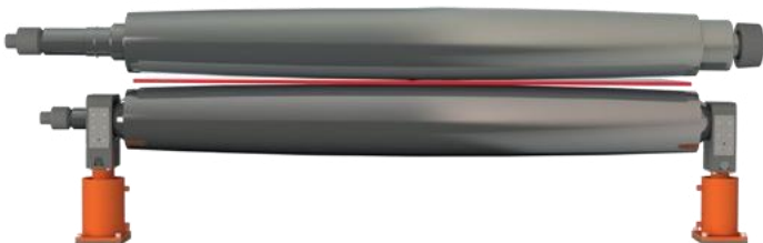
Grubość gięcia jest cieńsza niż ukoronowanie walcowe
